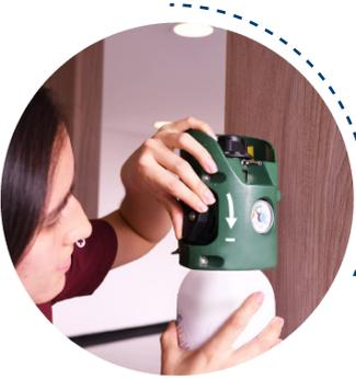
Verificar que la llave del manómetro esté abierta y conectar la manguera de la cánula nasal o la máscara al flujómetro.
